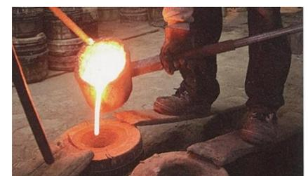
鑄込み（鑄型に鉄を流し込む）
