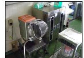
6 下処理～上処理～調理の動線が長い。野菜乾燥機がドライ対応機種ではない。
