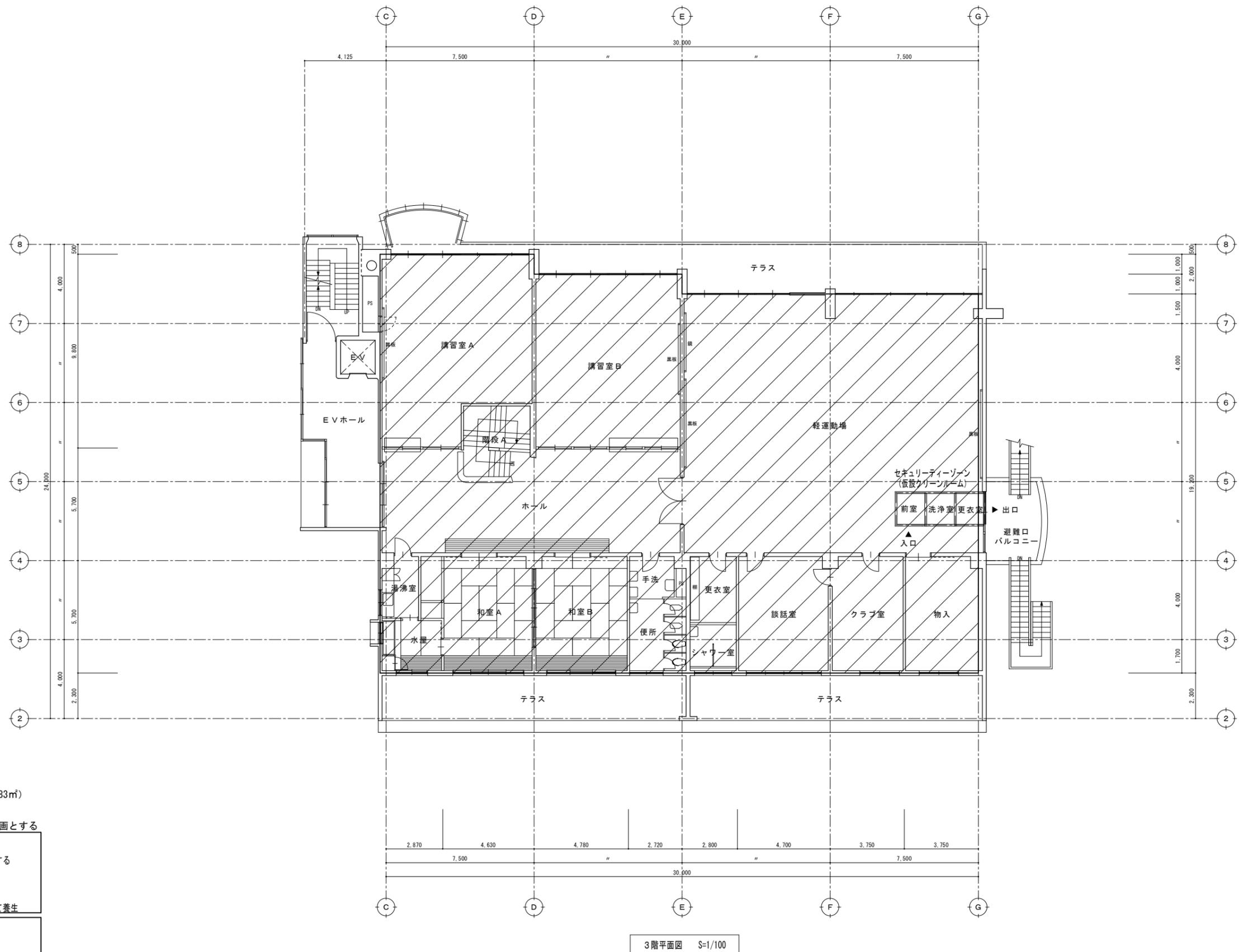
アスベスト除去レベル1作業範囲を示す（3階：養生床面積583㎡）
