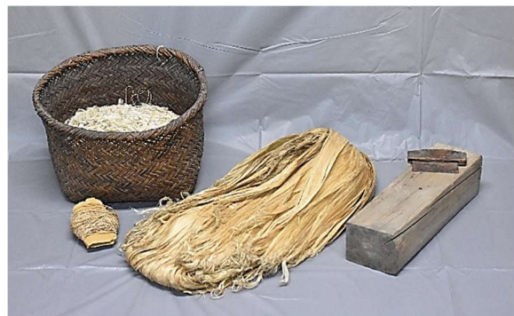
【右】苧引台（おひきだい）と引子（ひきこ） 麻の粗皮をこそぎ落とす道具。
