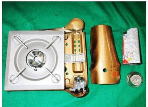
🔥ガスボンベが破裂したこんろ🔥
