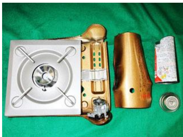
💧 ガスボンベが破裂したこんろ 💧
