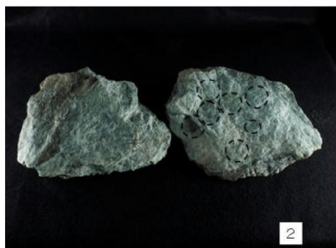
球果状(ノジュール状)のネフライトを割った状態です。1-1の表面が光沢を帶びていることに対し、1-2の割れた面は光沢がなく、全体的に片状に割れていることがわかります。2では片状でありながらも、小さい緑閃石集合体が含まれます。2のような原石には緑閃石の集合状態により亀裂のような狭い隙間があり(剪断構造か?)、その隙間を埋めるようにさらに細かい透・緑閃石が密集しています。その様子は研磨するとより見えるようになります。
