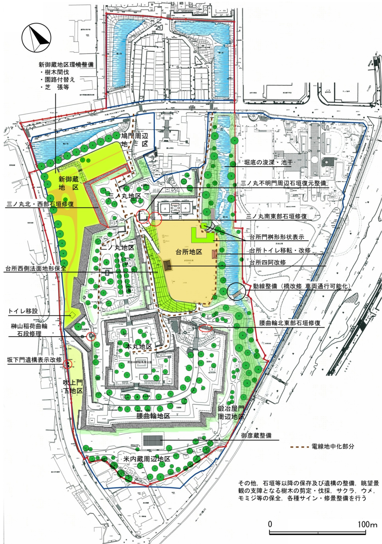
第 37 図 盛岡城跡整備計画平面図（第 I 期整備） ※主要整備内容のみ標記
