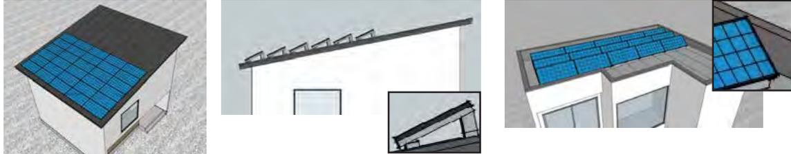
○ パネル角度を屋根勾配に合わせて設置している。
