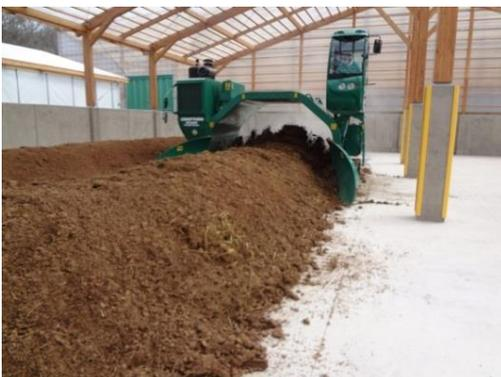
二次発酵舎では自走式の攪拌機を使って攪拌します。
