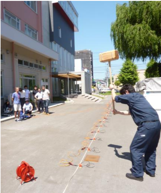
7月11日の「地震」の講義では地盤探査を実験。表面波高精度探査装置で模擬地震の振動の伝わり方や地盤解析の最新技術を学んだ
