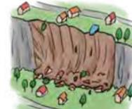
雨や雪どけ水、地震などの影響により斜面が急激に崩れ落ちる現象です。突然的に起こり、崩れ落ちるスピードが速いのが特徴です。
