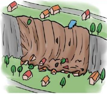
雨や雪どけ水、地震などの影響により斜面が急激に崩れ落ちる現象です。突発的に起こり、崩れ落ちるスピードが速いのが特徴です。
