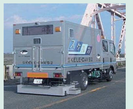
空洞化調査で市道の安全確保を
