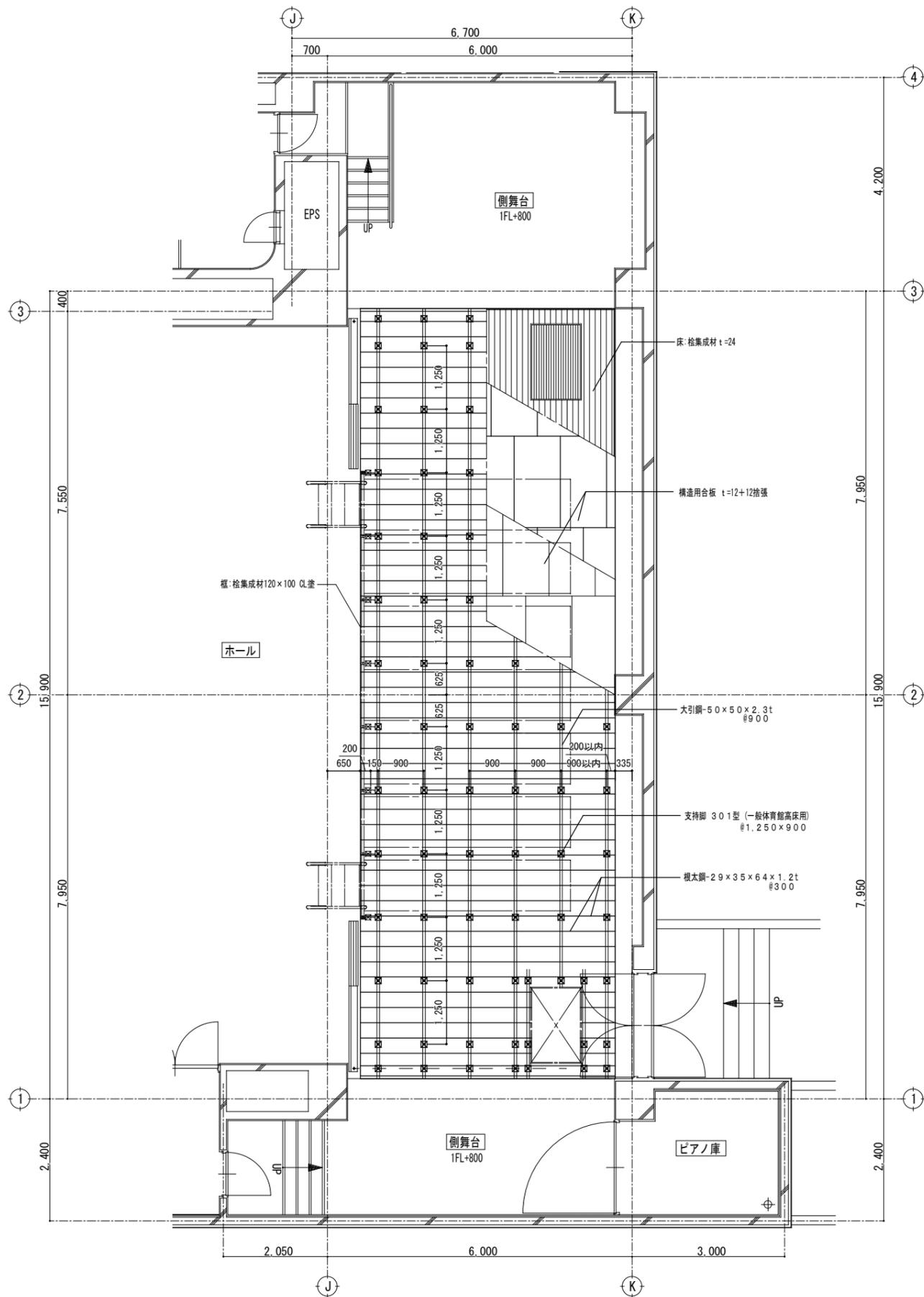
1階 舞台 鋼製床下地組断面図 S=1/20
