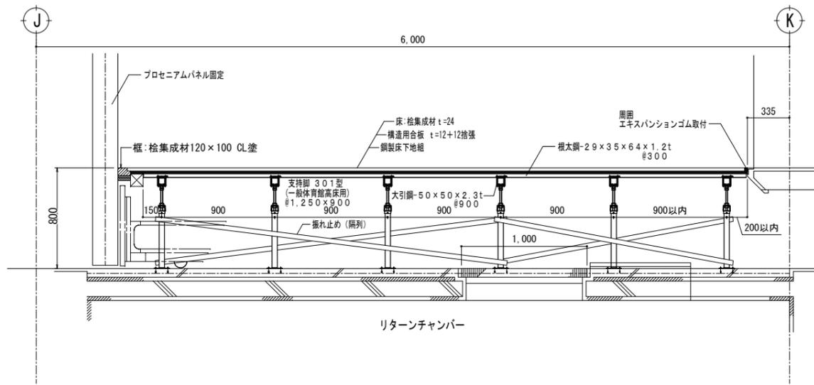
1階 舞台 鋼製床下地組断面詳細図 S=1/5
