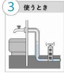
水抜き栓のハンドルを反時計回りに止まるまで回す
