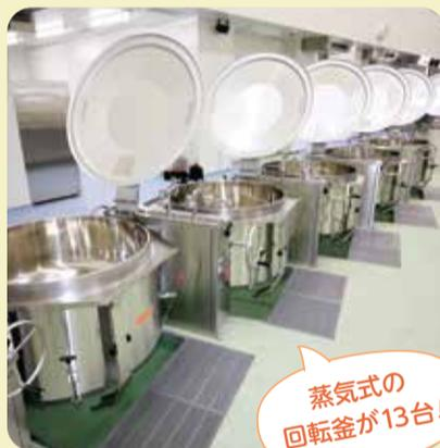
蒸気式の回転釜が13台!
