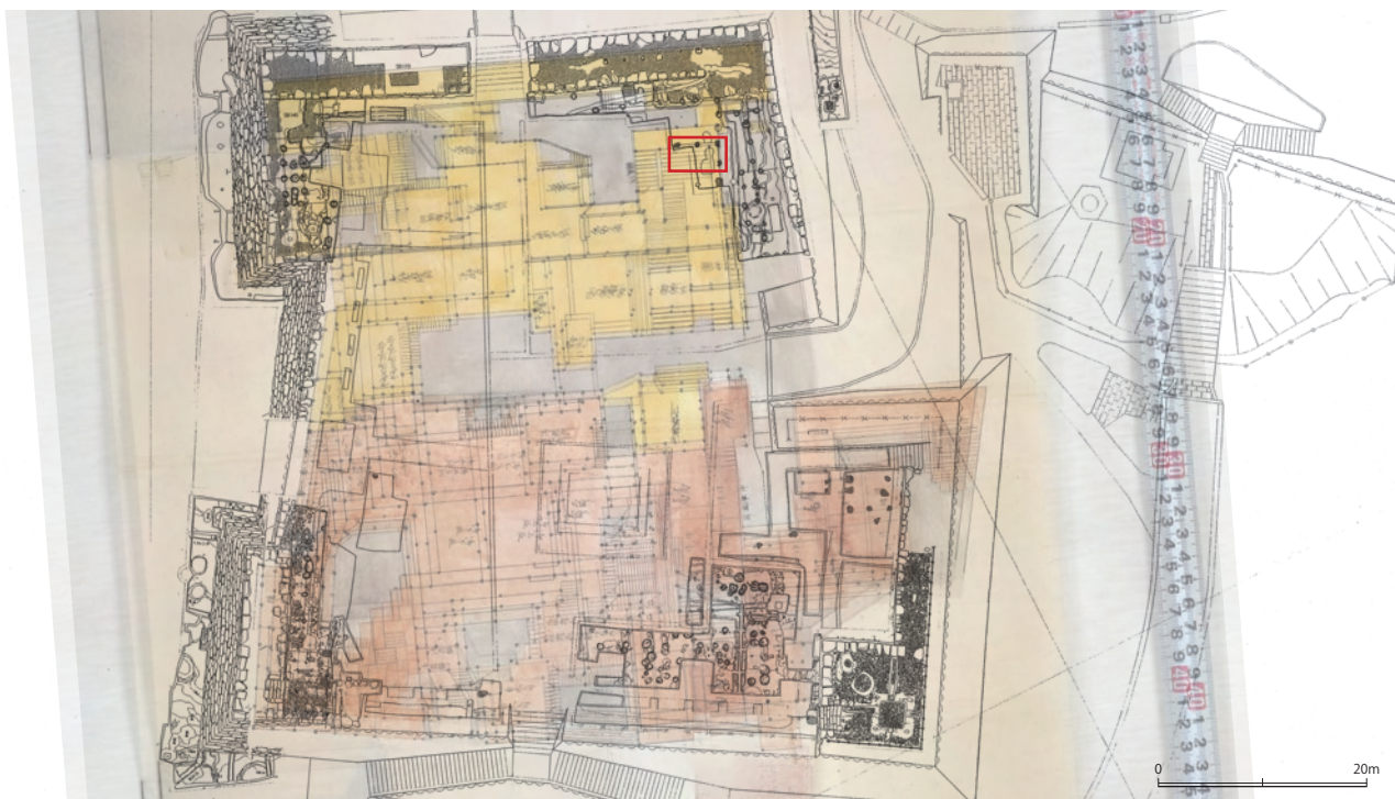
Fig.VIII.1 V期-V2期の重ね合わせ図（赤線囲み内の礎石に柱が合うように柱間を6.3尺と6.5尺にした絵図のオルソ画像を重ねている）
