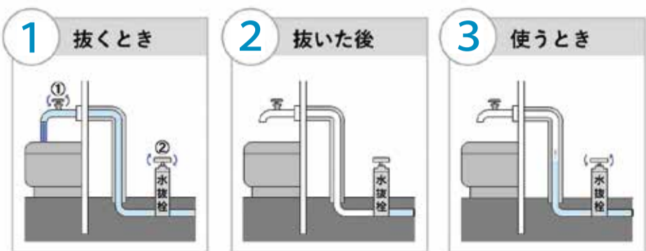
1 抜くとき 2 抜いた後 3 使うとき ①蛇口をいっぱいに開け水を出す ②水抜栓のハンドルを時計回りに止まるまで回す 蛇口は開けたままにしておく 水抜栓のハンドルを反時計回りに止まるまで回す
