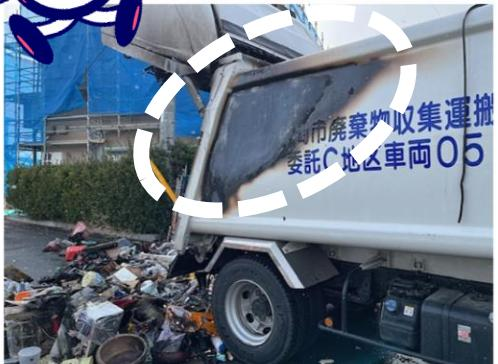
令和7年2月に盛岡地域内で、不燃ごみに混入していた「スプレー缶」による引火が原因で、ごみ収集車の車両火災が発生しました。幸いにも作業員は無事でしたが、ごみ収集車が大きな被害を受けました。
