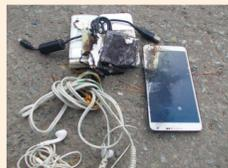
発火したリチウムイオン電池内蔵の製品
