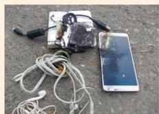
発火したリチウムイオン電池内蔵の製品
