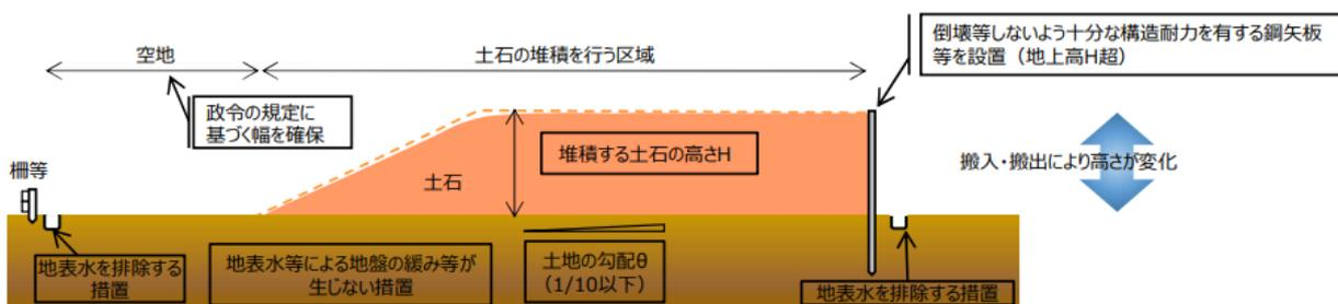
図9-3 鋼矢板等の設置の例
